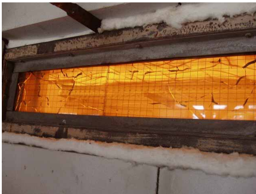
Slika 6. Pogled u komoru kroz prozor. Vidi se metalni žljeb u kome je položen kabel
