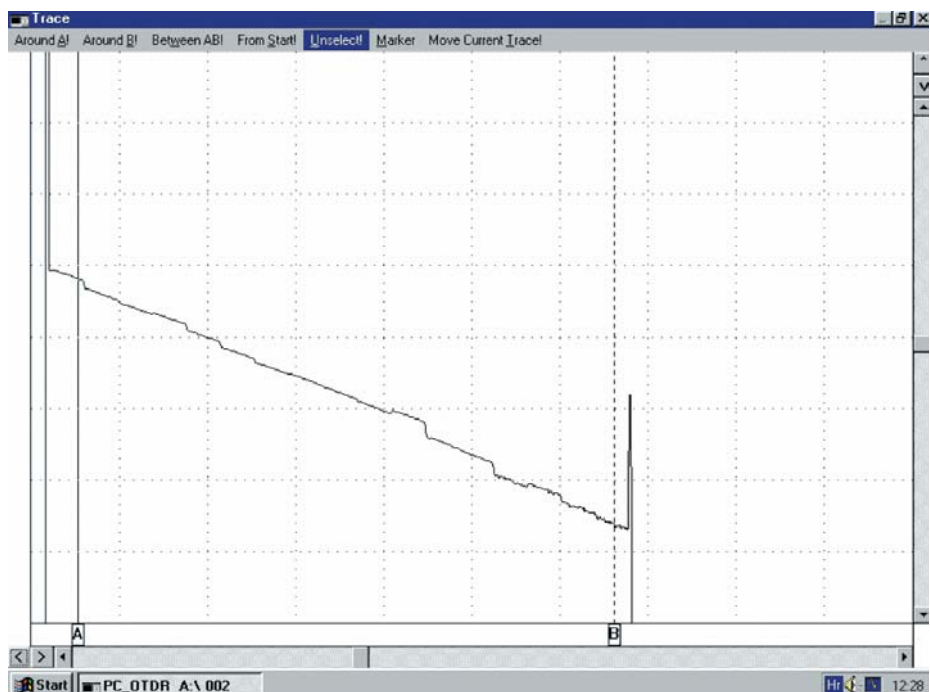
■ Slika 8. Krivulja prigušenja 16 svjetlovodnih vlakana spojenih u seriju
